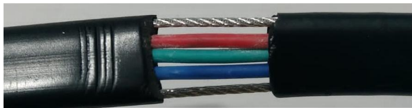
Рисунок Б.7 – Вскрытое место для установки термодатчика на плоском кабеле
